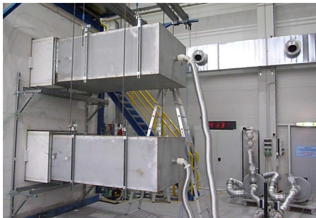
Rysunek 5. Ogólny schemat stanowiska do badania kłapy wentylacji pożarowej wraz z układem pomiaru przepływu i kontroli ciśnienia. Źródło: PN-EN 1366-10+A1:2025-03
