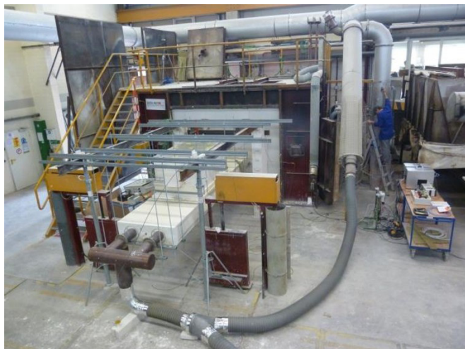
Rysunek 5. Ogólny schemat stanowiska do badania kłapy wentylacji pożarowej wraz z układem pomiaru przepływu i kontroli ciśnienia. Źródło: PN-EN 1366-10+A1:2025-03
