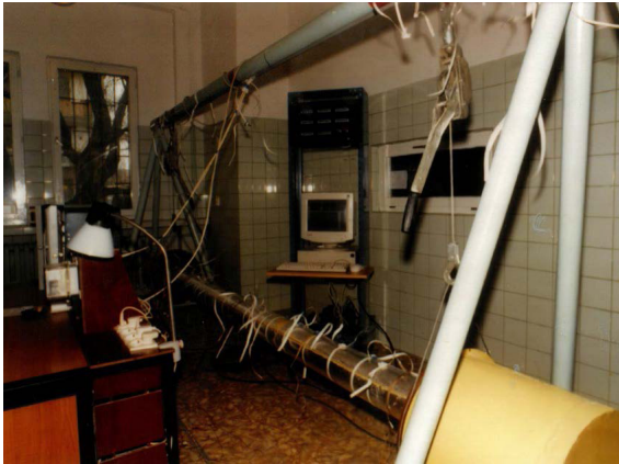
Fotografia 1. Aparat rurowy zbudowany w Laboratorium Badawczym pod koniec lat osiemdziesiątych ubiegłego wieku wg ASTM C335 (ASTM, 1995). Źródło: opracowanie własne Photo 1. A pipe testing apparatus built at Testing Laboratory in the late 1980s in accordance with ASTM C335 (ASTM, 1995). Source: author's own study
