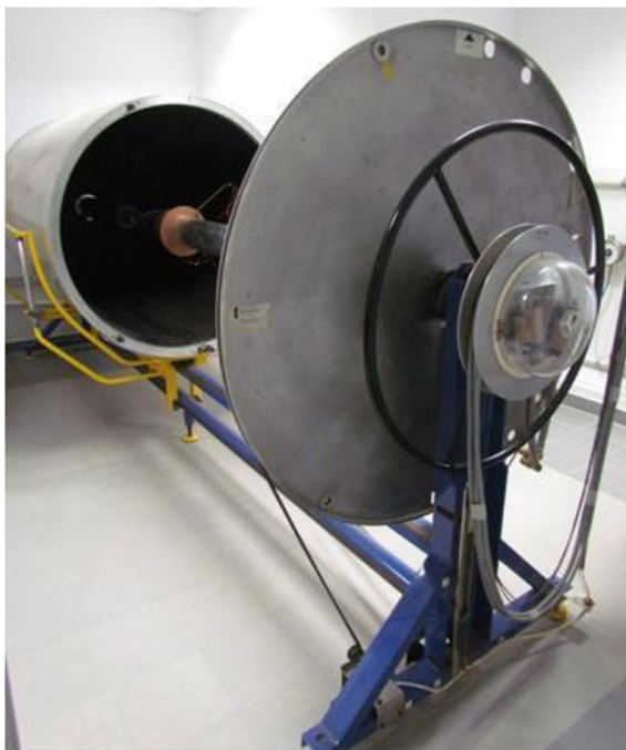
Fotografia 1. Aparat rurowy zbudowany w Laboratorium Badawczym pod koniec lat osiemdziesiątych ubiegłego wieku wg ASTM C335 (ASTM, 1995). Źródło: opracowanie własne Photo 1. A pipe testing apparatus built at Testing Laboratory in the late 1980s in accordance with ASTM C335 (ASTM, 1995). Source: author's own study
