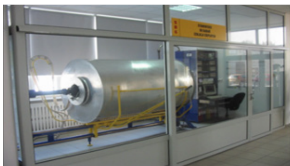
Fotografia 2. Nowy aparat rurowy zbudowany wg PN-EN ISO 8497 (PKN, 1999). Źródło: opracowanie własne Photo 2. New pipe testing apparatus manufactured in accordance with PN-EN ISO 8497 (PKN, 1999). Source: author's own study
