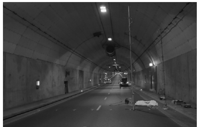
Rysunek 2. Statywy pomiarowe umieszczone w tunelu. Źródło: opracowanie własne Figure 2. Stand poles positioned within the tunnel's measurement section. Source: authors' own study
