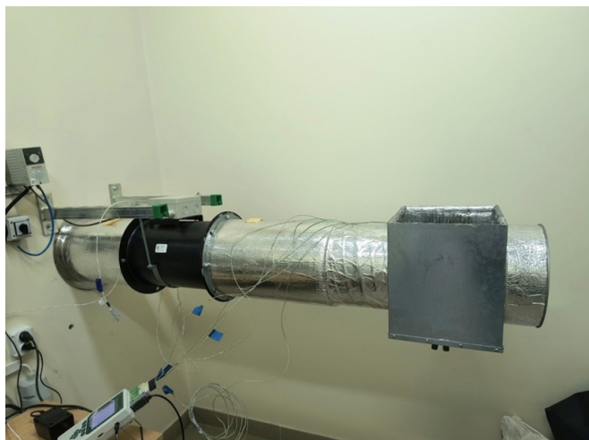
Rysunek 1. Zdecentralizowane urządzenie fasadowe. Źródło: zasoby własne Figure 1. Decentralised facade unit. Source: authors' own study
