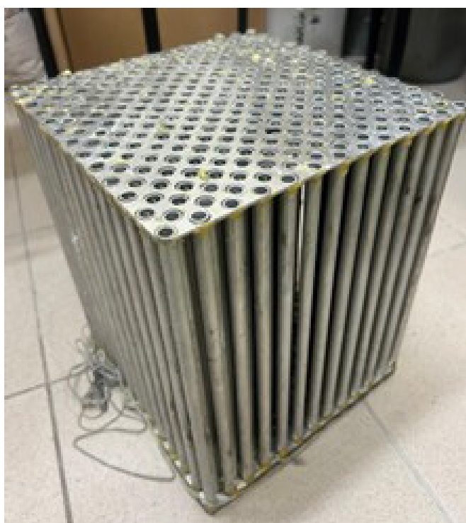
Rysunek 2. Wymiennik do odzysku ciepła. Źródło: zasoby własne Figure 2. Heat exchanger. Source: authors' own study
