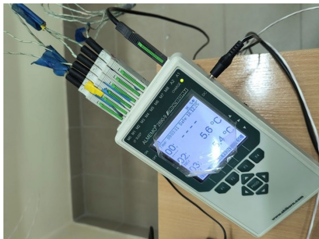
Rysunek 3. Rejestrator ALMEMO 2890-9. Źródło: zasoby własne Figure 3. ALMEMO 2890-9 recorder. Source: authors' own study
