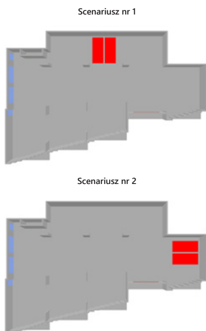
Rysunek 3. Lokalizacje pożaru projektowego w garażu; źródło: opracowanie własne
